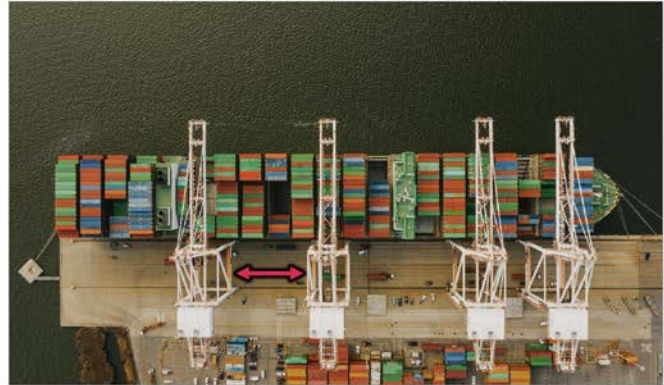
Containerschiffe werden von mehreren STS-Kranen gleichzeitig beladen. Diese müssen Abstand zueinander wahren.
